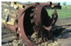
Boorkop en baggerbuizen (PCPP20110926026)
