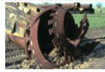
Boorkop en baggerbuizen (PCPP20110926026)
